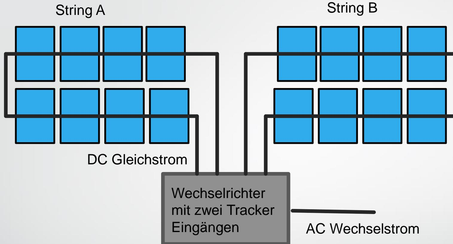
Mehrere Module sind zu **Strings** in Reihe geschaltet, um höhere Spannungen zu generieren.
